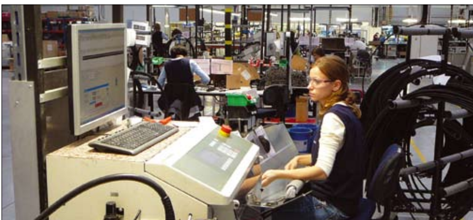
Schleuniger PowerStrip 9500 für die Jumperproduktion
