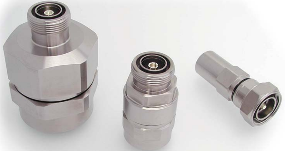
50 Ohm – Konnektoren, von links: 7/16F für 1-5/8" Annularkabel, 7/16F für 7/8" Annularkabel und 7/16M für 1/2" Superflexkabel
