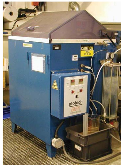
La chambre climatique pour les tests en environnement salin.
