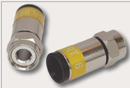
La partie interne du connecteur UltraEase™ est en polymère noir résistant aux UV et la partie externe en alliage laiton C 36000.
