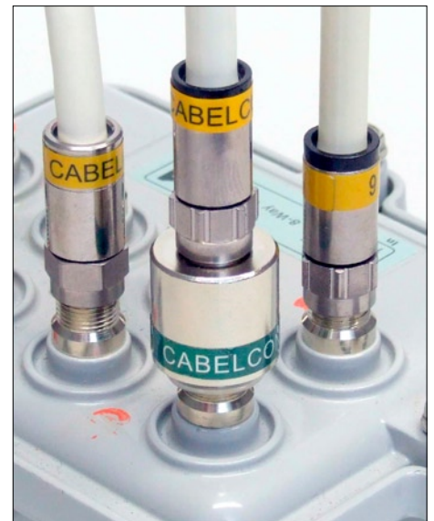
CTP-R75 diebstahlsicherer Abschlusswiderstand mit "blinder Verbindung" (nur Gewinde) für nicht genutzte Teilnehmerkabel.
