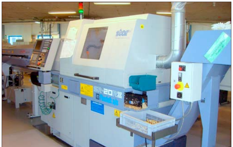
Eine fabrikneue STAR SR-20R II für die schnelle Herstellung von Zwischenbauteilen
